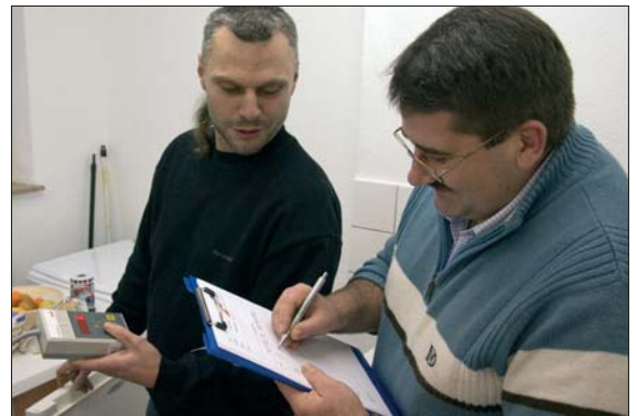
Umweltscouts messen den Stromverbrauch bei Elektrogeräten im Stand-by-Betrieb.
